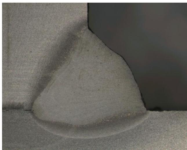
**Рис. 5** Поперечный шлиф, угловой шов, положение сварки РВ
