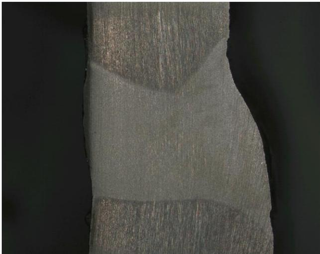
**Рис. 10** Шов встык без подготовки кромок, толщина листа 6-8 мм, без сварочных волокон, ручная сварка, положение сварки РС
