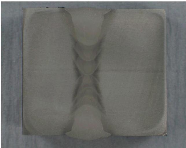
**Рис. 11** Толщина листа 40 мм, механизированная сварка, положение сварки РА
